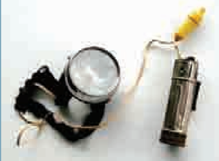
Photo 5 La première lampe frontale électrique en usage en 1953. Il s'agit du corps d'une torche électrique, décapitée de son phare. En guise d'interrupteur une poire en plastique. (Photo by Sami Karkabi)
