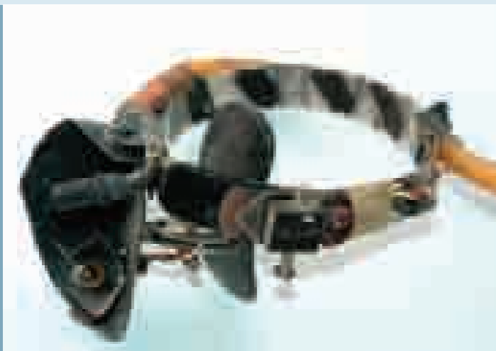
Photo 7 Le bec est posé à l'intérieur d'un réflecteur en inox fixé à un serre-tête métallique recouvert de tissu mousse. Le tissu est relié au réservoir à carbure par un tuyau en plastique. Un adaptateur sur le côté règle le serre tête à volonté. Un protège front de forme elliptique protège l'avant-crâne de l'échauffement du réflecteur. (Photo by Sami Karkabi)
